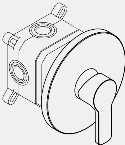
L'installateur doit, pendant la phase de montage, considérer que le trou dans le mur doit avoir une profondeur maximale de 72 MM. Il doit également considérer que l'épaisseur des carreaux est d'environ 10 MM. En conclusion, la profondeur du trou dans le mur doit être de 65 MM.
