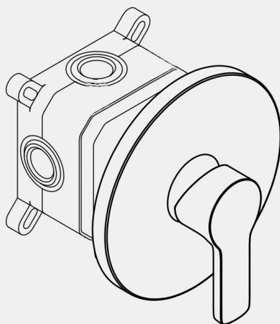
L'installatore o comunque l'utilizzatore finale, in fase di montaggio, deve considerare che il foro può avere una profondità massima di 72 MM. Inoltre, si deve tenere in considerazione che lo spessore delle piastrelle è di circa 10 MM. Dunque, la profondità del foro nel muro dovrà essere di 65 MM.
