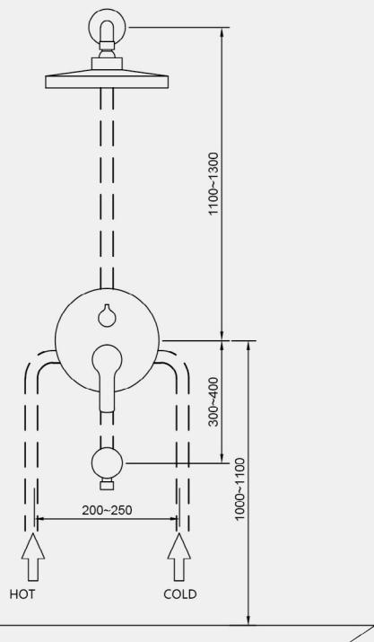
L'installatore o comunque l'utilizzatore finale, in fase di montaggio, deve considerare che il foro può avere una profondità massima di 72 MM. Inoltre, si deve tenere in considerazione che lo spessore delle piastrelle è di circa 10 MM. Dunque, la profondità del foro nel muro dovrà essere di 65 MM.
