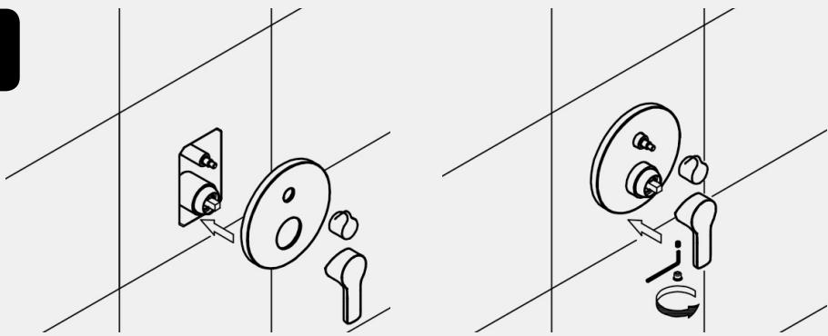
Utiliser les vis pour fixer la cassette encastrée du mitigeur au mur.
