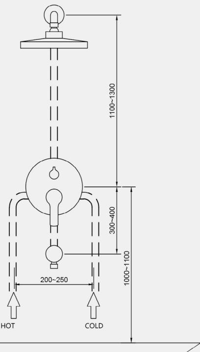
Pour avoir une installation correcte de la cassette encastrée du mitigeur, le fond du trou doit être plat. Taille recommandée : 160 x 100 x 65 MM.
