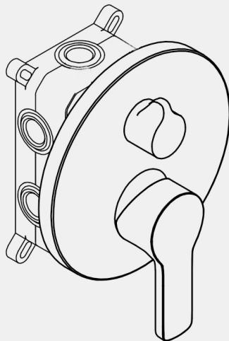
L'installateur doit, pendant la phase de montage, considérer que le trou dans le mur doit avoir une profondeur maximale de 72 MM. Il doit également considérer que l'épaisseur des carreaux est d'environ 10 MM. En conclusion, la profondeur du trou dans le mur doit être de 65 MM.
